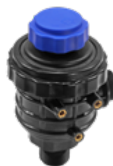
Filtro de sucção com válvula, saídas de rosca 1 1/4" capacidade de 80 l/min. elemento filtrante malha 50
